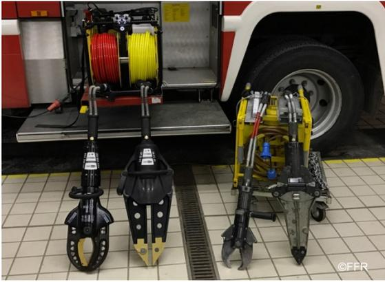
Mit einem hydraulischen Rettungsgerät werden Personen, welche nach einem Verkehrsunfall in ihrem Fahrzeug eingeklemmt sind, befreit. Diese Anschaffung wurde notwendig, da das mittlerweile in die Jahre gekommene Aggregat (Baujahr 1986, rechts im Bild) bei hochfesten Werkstoffen, die in moderneren Unfallfahrzeugen zunehmend verbaut werden, an die Grenzen der Leistungsfähigkeit stößt.
